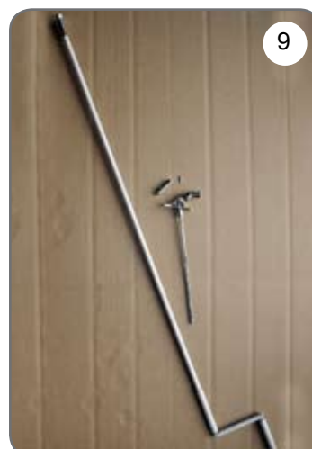
Korba, przegub Cardana 45° lub 90° z zaczepem dzwinkowym [9].
